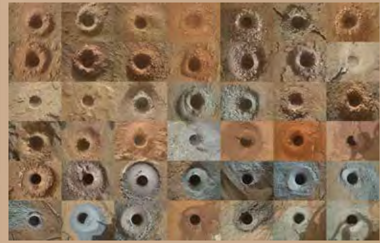
Dal 2013 Curiosity ha raccolto più di 40 campioni di roccia utilizzando la trivella montata all'estremità del suo braccio robotico. Dopo aver perforato un campione, la composizione della roccia polverizzata viene analizzata dagli strumenti a bordo del rover. Recentemente è stato trovato zolfo puro: una presenza inattesa che cambia la lettura geologica del pianeta rosso
