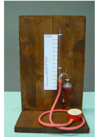
Manometro a immersione costruito dagli studenti della 1 a B LSSA
