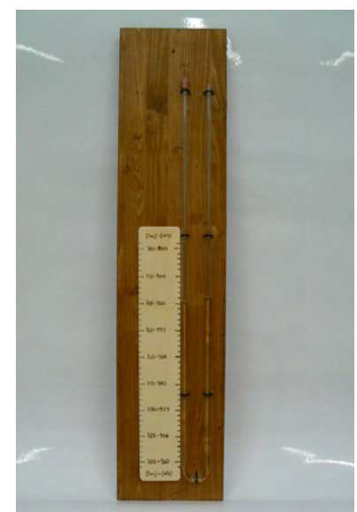
Barometro differenziale costruito dagli studenti della 1 a B LSSA
