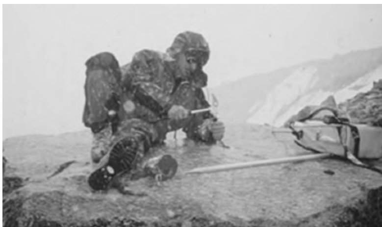
Spedizione 1999. Giorgio Vassena impegnato nelle operazioni di materializzazione del chiodo di riferimento sul vertice «di velocità» V300 posto nella parte medio-alta del ghiacciaio (Foto di Simone Radovan)
