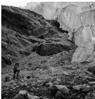
Spedizione 1998. Misurazione della posizione della fronte del ghiacciaio mediante stazione totale (Foto di G. Carcano)
