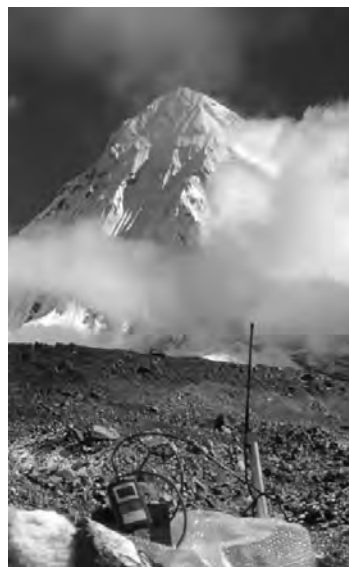
Spedizione 1999. Immagine del ponte radio attivo presso il campo base. Si osserva in primo piano un modem, appoggiato alla batteria e con a fianco l'antenna omnidirezionale per la trasmissione della correzione differenziale nelle misurazioni con GPS in RTK. Sullo sfondo il monte Pumori (7100 metri).
