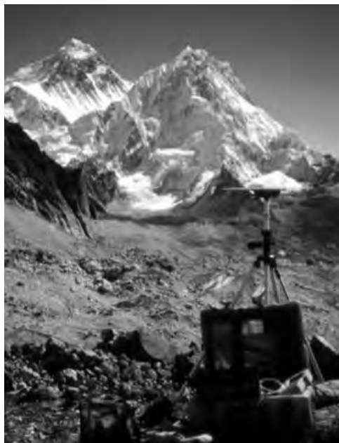
Spedizione 1998 quota 5 500 metri. Immagine del vertice di stazione 6 durante le operazioni di misurazione statica. Sullo sfondo a sinistra il monte Everest (Foto di Giorgio Vassena)
