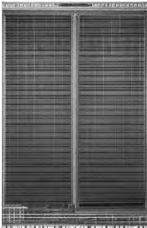
Memoria flash realizzata in tecnologia da 150 nm; il chip ha un'area inferiore a 0,5 cm 2 e contiene più di 70 milioni di transistori
