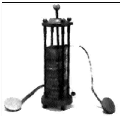
Esemplare del primo modello di pila voltaica (Tempio Voltaico, Cuneo)
